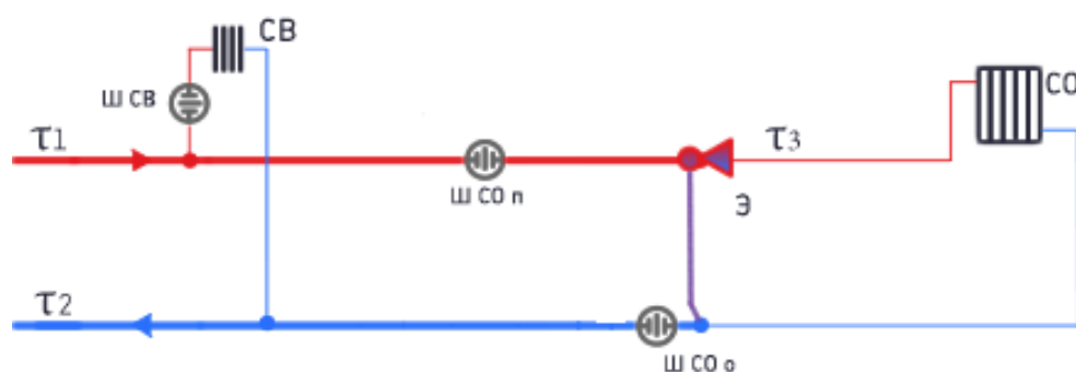
Рәсем 6-кулланучыларны ике торбалы жылылык челтәренә тоташтыру схемасы (йорт эчендә жылыту системасы булганда), температураны көйләүче буларак элеватор (жылыту CO – системасы, Э – элеватор, СВ – вентиляция системасы) кулланыла.
