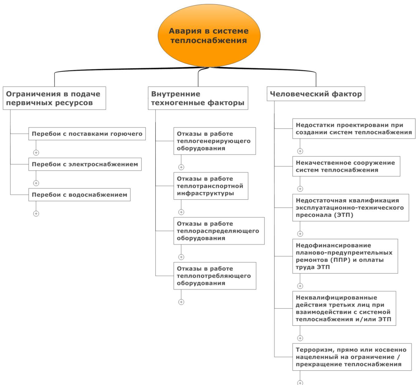
Рисунок 5 – Базовые причины аварий систем теплоснабжения
