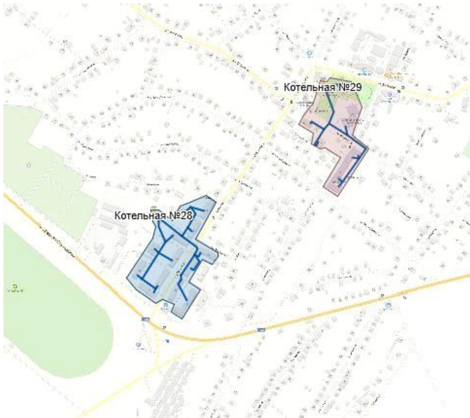
Рисунок 6 – Зоны теплоснабжения Котельной №28, Котельной №29
