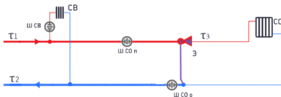
Рисунок 3 - Схема подключения потребителей к двухтрубной тепловой сети (при наличии внутридомовой системы отопления), зависимое присоединение, без смешения
