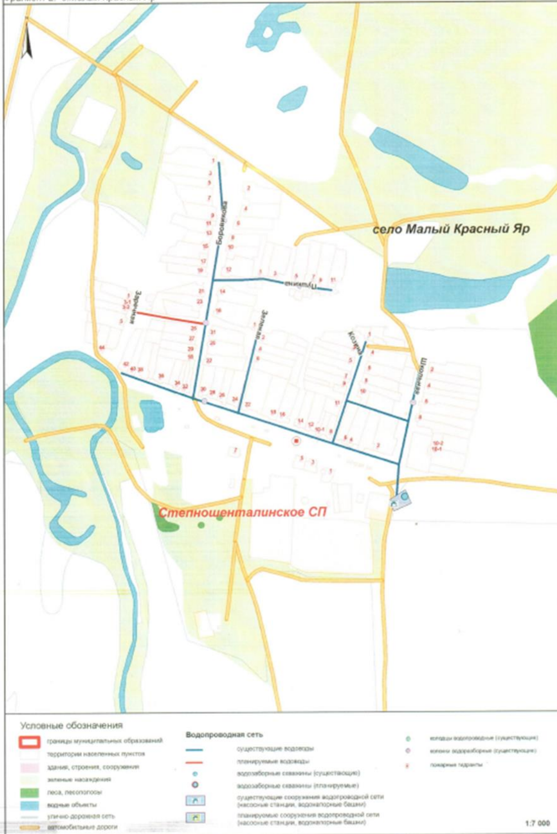
1 нче рәсем. Үзәкләштерелгән су белән тәэмин итү системалары объектларының гамәлдәге урнашу картасы (схемасы)
