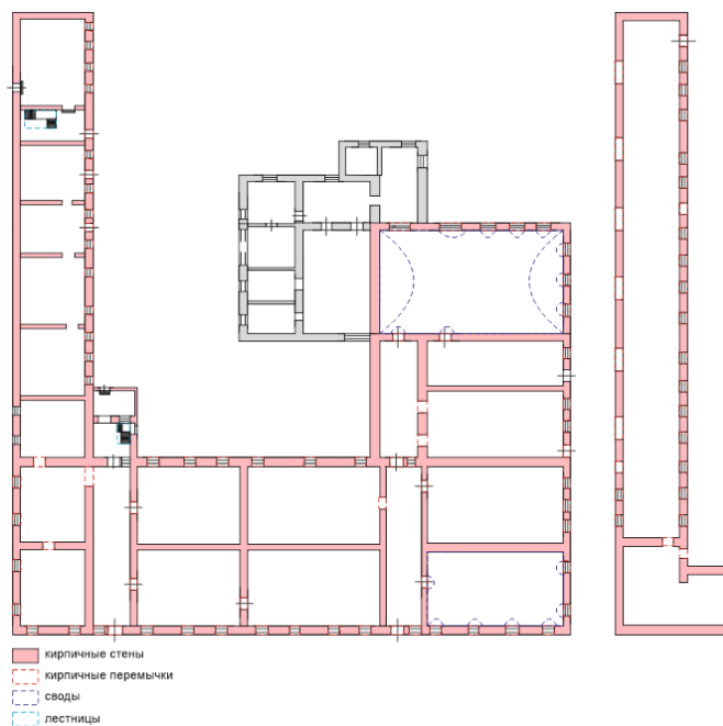
7 нче рәсем. Конструктив схема
