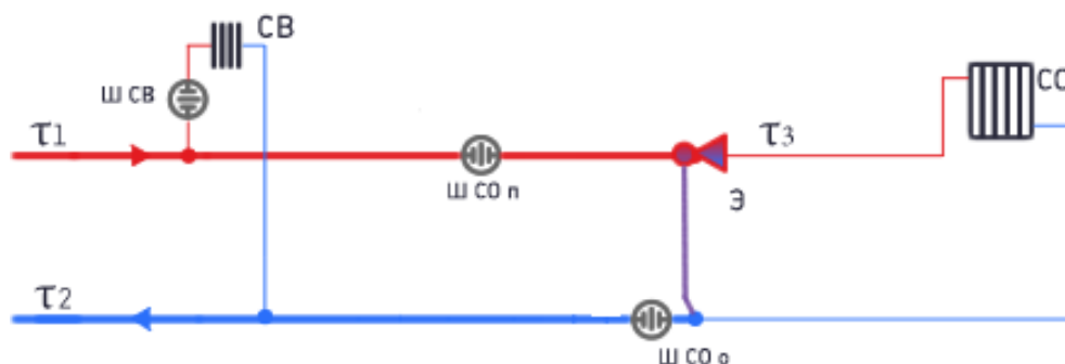
Рисунок 6 – Схема подключения потребителей к двухтрубной тепловой сети (при наличии внутридомовой системы отопления), в качестве регулятора температуры используется элеватор (СО – система отопления, Э – элеватор, СВ – система вентиляции)
