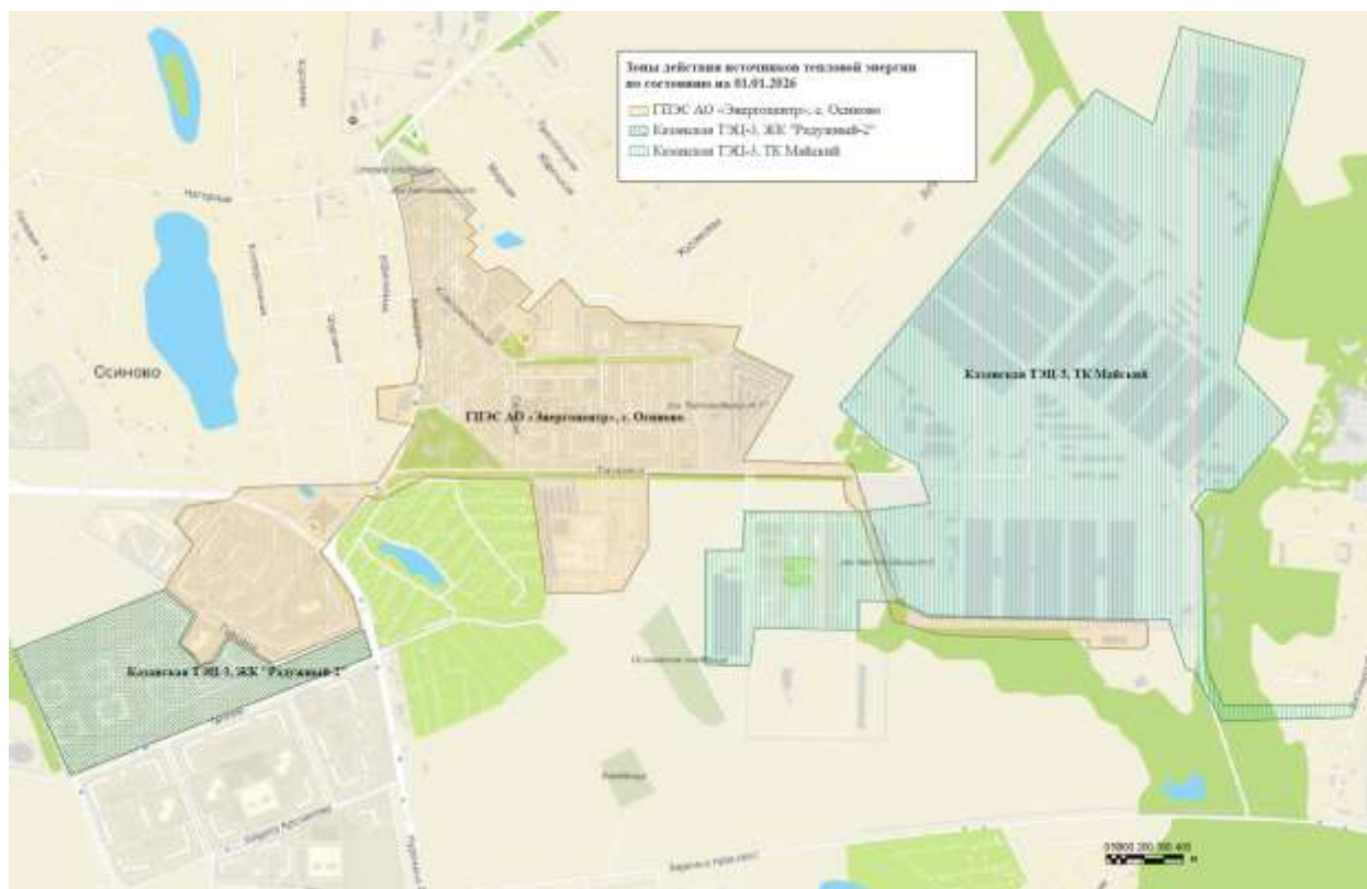
Рисунок 2.1.1 – Зоны действия источников тепловой энергии по состоянию на 01.01.2026
