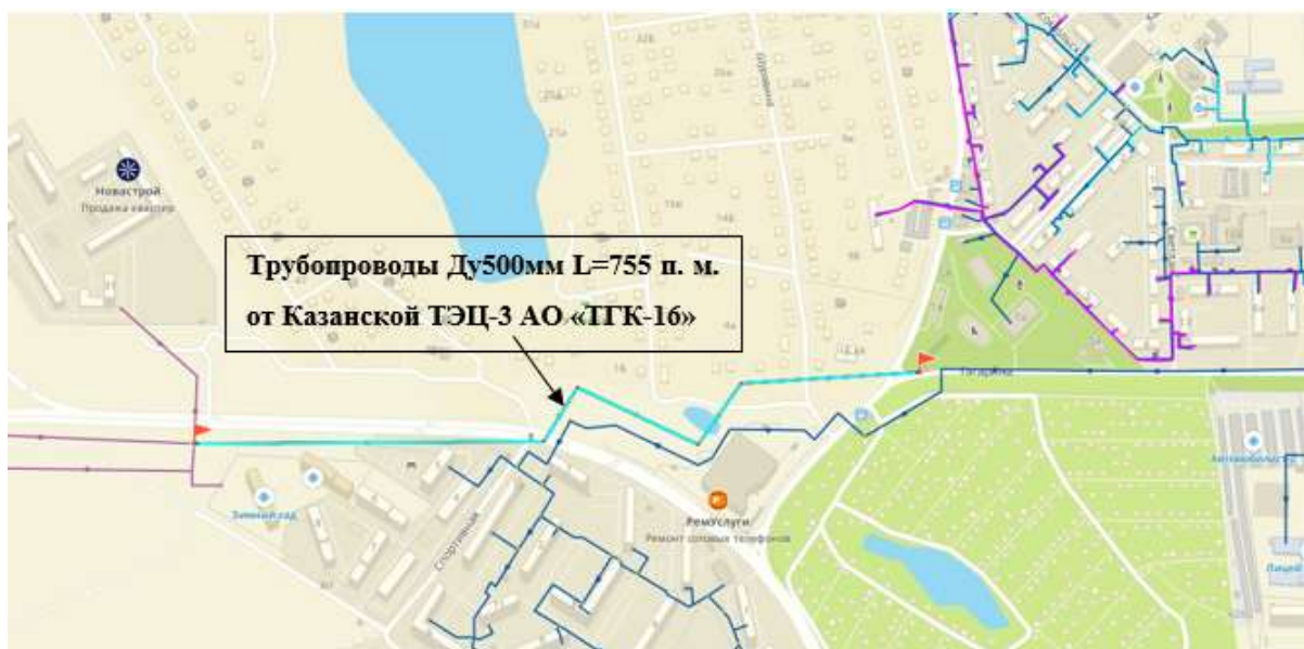
Рисунок 4.1.2 – Трубопроводы Ду500мм L=755 п. м. от Казанской ТЭС-3 АО «ТГК-16»
