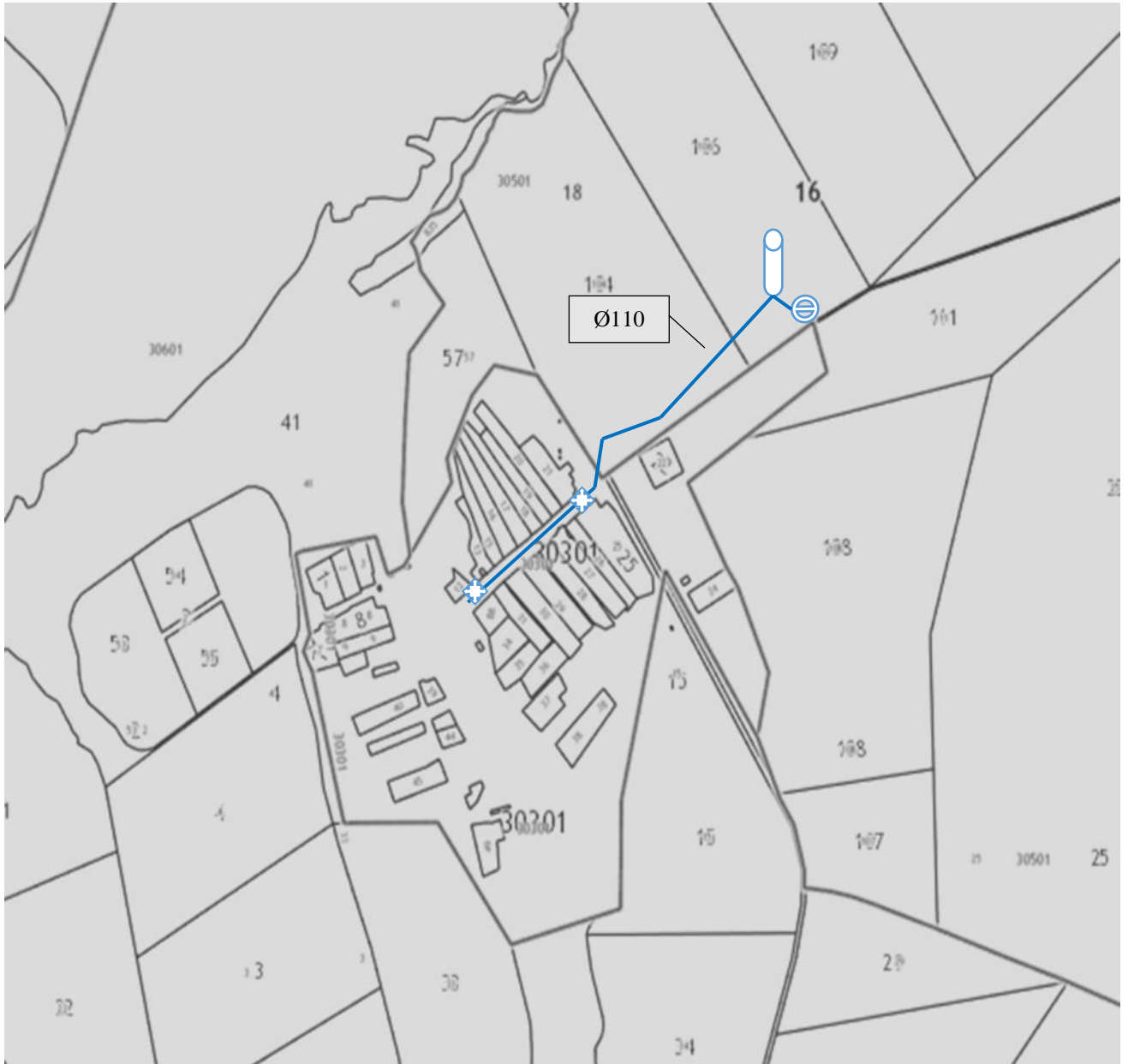
Рисунок 15. Схема расположения существующих водозаборных сооружений и водопроводной сети на территории деревни Токмашка
