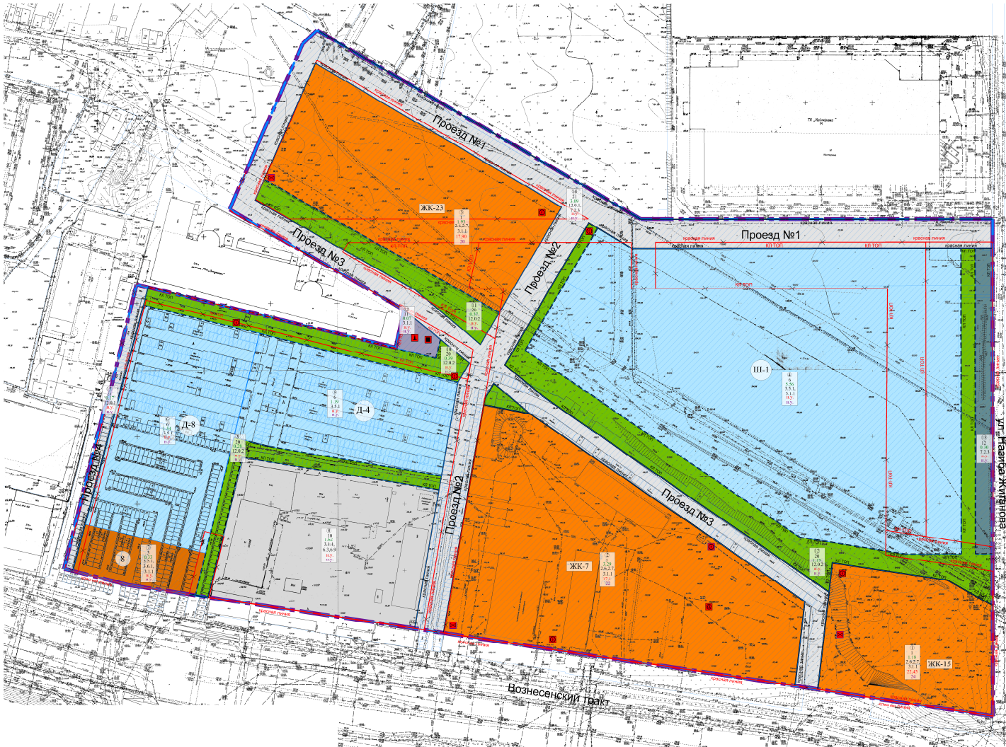
II. Фрагмент чертежа планировки территории с указанием красных линий, границ элементов планировочной структуры и зон планируемых размещений объектов капитального строительства (2 очередь)
