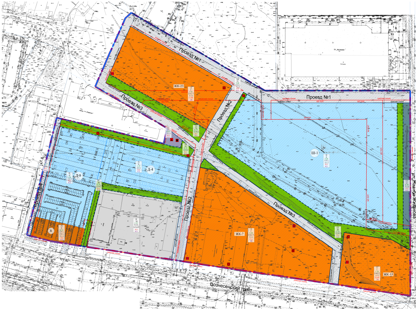
1. Фрагмент чертежа планировки территории с указанием красных линий, границ элементов планировочной структуры и зон планируемых размещений объектов капитального строительства (1 очередь)
