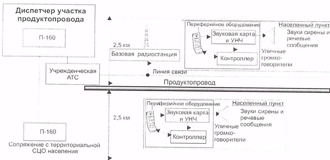
Рисунок 3.10.2. Схема построения системы оповещения на продуктопроводе
