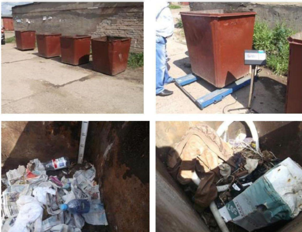
Рис.7.1.2.83. Определение нормативов накопления ТКО от автотранспортных учреждений. Гаражи, г.Набережные Челны, ул.Железнодорожников, д.2.
