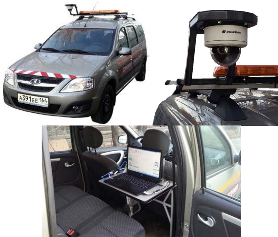
Рисунок 4 – Измерительный комплекс – передвижная дорожная лаборатория КП-514СМП на базе автомобиля «LADA Largus»
